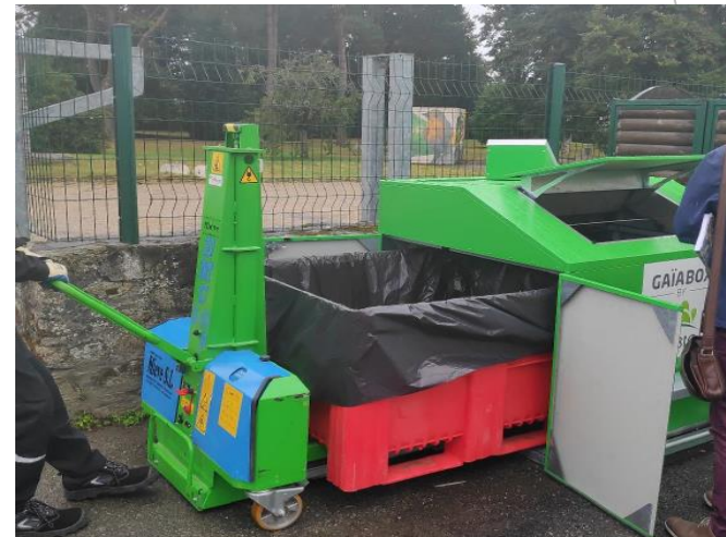
Abri bac AXIBIO: trappe de vidage, collecte par transpalette
