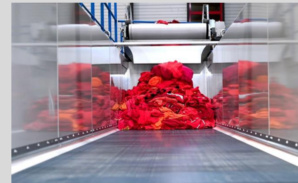
Qualification des textiles par composition et par couleurs grâce à des technologies de tri optique
