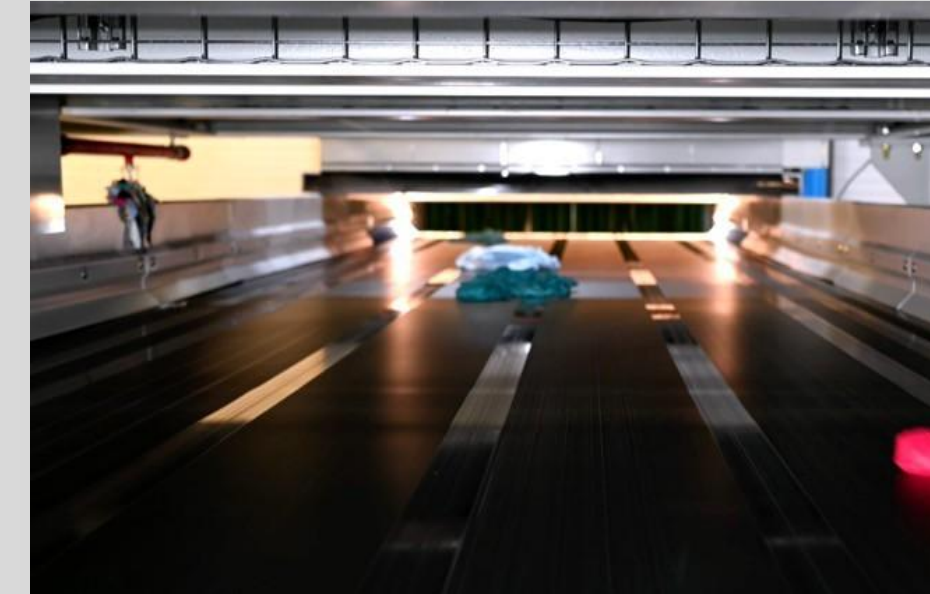
Qualification des textiles par composition et par couleurs grâce à des technologies de tri optique
